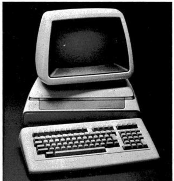
invece, che utilizza il microprocessore Z 80 di 64 K di memoria RAM, si può connettere un secondo processore, il 6502 implementato nell'Apple II, nell'Atari e nel Vic 20.
