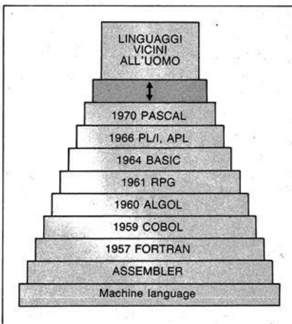
dine sistematico, provvede ad accendere o a spegnere (0/1 - sistema di codifica binaria) le migliaia di microinterruttori contenuti nel *chip*. Per ottenere questo è necessario che le istruzioni siano date in modo comprensibile al computer, occorre cioè codificare le istruzioni in LM. Tutto il *software* prodotto in linguaggi evoluti compie questa traduzione automaticamente.
