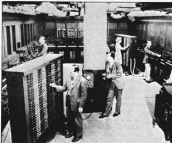
L'ENIAC ( Electronic Numerical Integrator and Calculator ), costruito nel 1942; i suoi circuiti contenevano 18 000 valvole e 1500 relé. Macchina costosissima e di enormi dimensioni (occupava un locale di 300 m 2 ), aveva una memoria assai ridotta.
